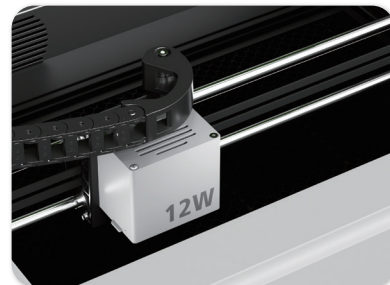
6. Limpieza y mantenimiento del láser: Se recomienda limpiar el ventilador del láser cada 3 a 6 meses y limpiar las lentes del láser semanalmente para garantizar la potencia del láser.
