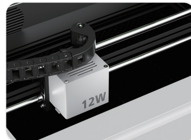
6. Nettoyage et entretien du laser : Il est recommandé de nettoyer le ventilateur du laser tous les 3 à 6 mois et les lentilles du laser chaque semaine afin de garantir la puissance du laser.
